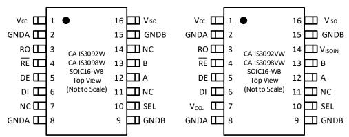
Figure 6-1. CA-IS3092W/CA-IS3098W/CA-IS3092VW/CA-IS3098VW SOIC16 Top View
